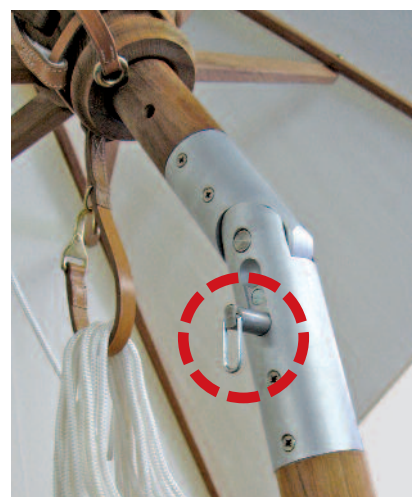
Knickmechanismus: Zum Knicken den Bolzen am Knickmechanismus herausziehen, Schirm knicken und den Bolzen wieder einführen.
